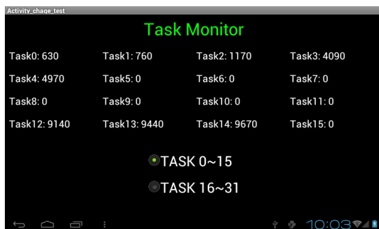
・各タスクの実行中の文番号をモニターする画面です。一度に32タスクぶん読むとトロくなるのでTASK0~15とTASK16~31に分けました(表示にgridViewを使いましたが、それが遅いようにも思えます。)MPCのプログラムに依存しないのでデバッグに使えます。
