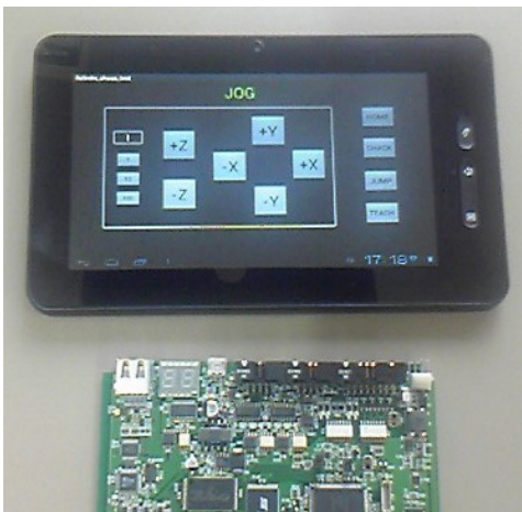
実勢価格約1万円の中国製タブレット Android 4.0.1。 このタブレットのタッチパネルは静電容量方式のためか誤動作(タッチしていないボタンが動作する)することがあります。
