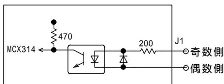
J1は差動入力インタフェースです。+側が200 の抵抗経由で内部フォトカプラのアノード側に接続され、-側がカソード側に接続されています。LED9-16はこのフォトカプラ入力の極性キャンセルダイオードとして実装されています。このためLEDの点灯は信号OFFを意味します。
