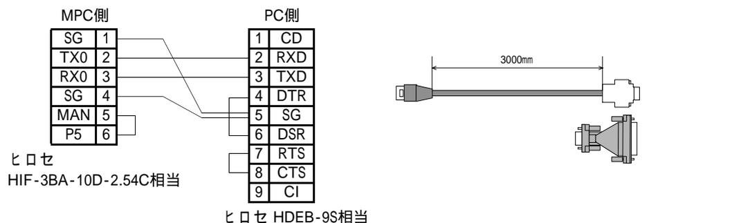
MPCとパソコンを接続する純正ケーブルです。基本ケーブルはDOS/V用となっておりますが、25ピン変換コネクタが付属してありPC98にもそのまま使用できます。
