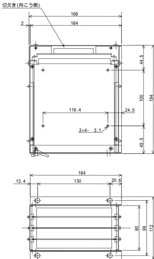
ボードの挿入はバスボードの上下に注意し、カードエッジのピン番号とバスボードのシルク印刷された番号を整合してください。
