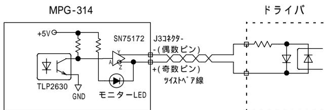
差動出力パルスインタフェースです。標準状態はCW,CCWの2パルス方式が内部レジスタ設定によりPULSE/DIR方式にも変更できます。
