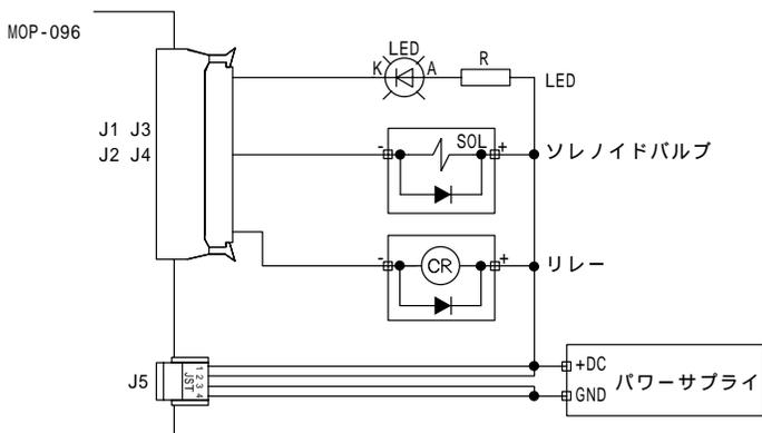
出力の制御電流は最大100mA、ソレノイドバルブ、リレーはダイオード付きを使用
